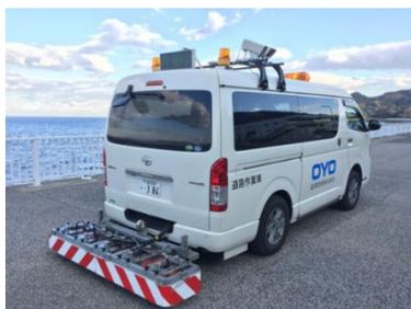
**地中レーダ式 路面下空洞探査車**
